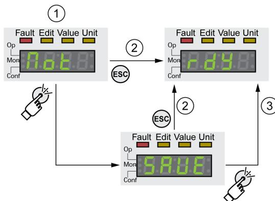
**1** HMI 显示，电机的更换已被识别出。
