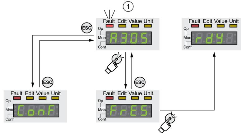
1 HMI 显示包括故障代码的故障信息
