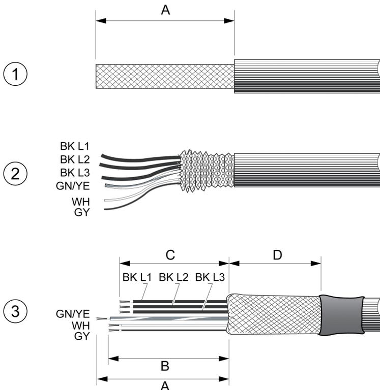
1 剥除长度为 A 的电缆护套。
