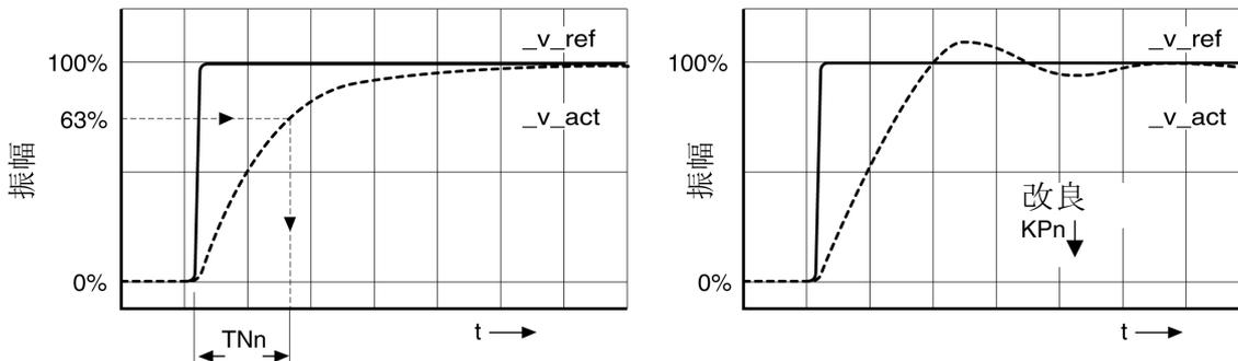
对于那些在达到非周期谐振边缘之前出现振动的驱动系统而言，必须尽量减小比例系数“KPn”，直到正好能察觉没有振动时为止。这种情况常常出现在同步皮带传动的直线轴上。
