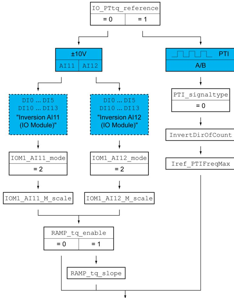
以下图表显示了现场总线控制方式下可进行设置的参数的概况：
