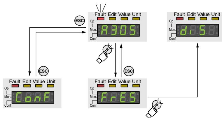
对于故障级别1的故障，重置故障信息将使运行状态7 Quick Stop Active转换回运行状态6 Operation Enabled。
