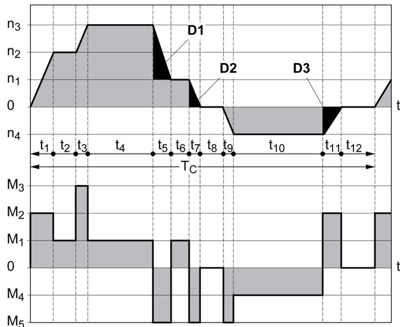
这两条特性曲线也可在确定电机参数时使用。需要加以考虑的特性曲线区段通过符号 D<sub>i</sub> ( D<sub>1</sub> ... D<sub>3</sub> ) 进行标示。
