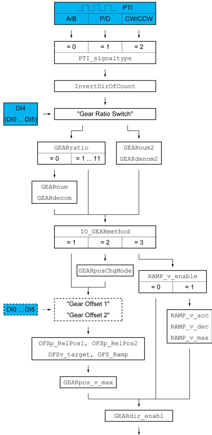
以下图表显示了现场总线控制方式下可进行设置的参数的概况：
