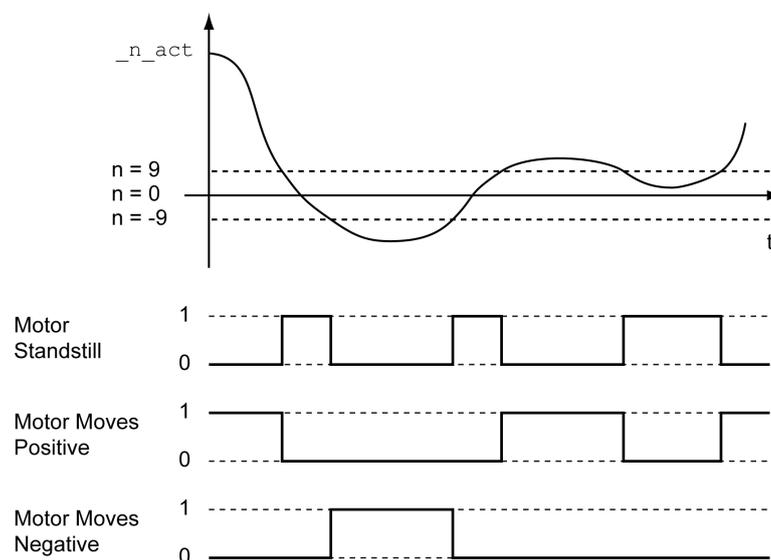
可以通过信号输出来显示状态。要显示状态，必须完成信号输出功能“Motor Standstill”、“Motor Moves Positive”或“Motor Moves Negative”的参数设定，请参阅数字信号输入和数字信号输出, 180 页。
