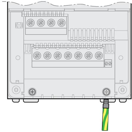
将设备的接地与中央接地点连接起来。
