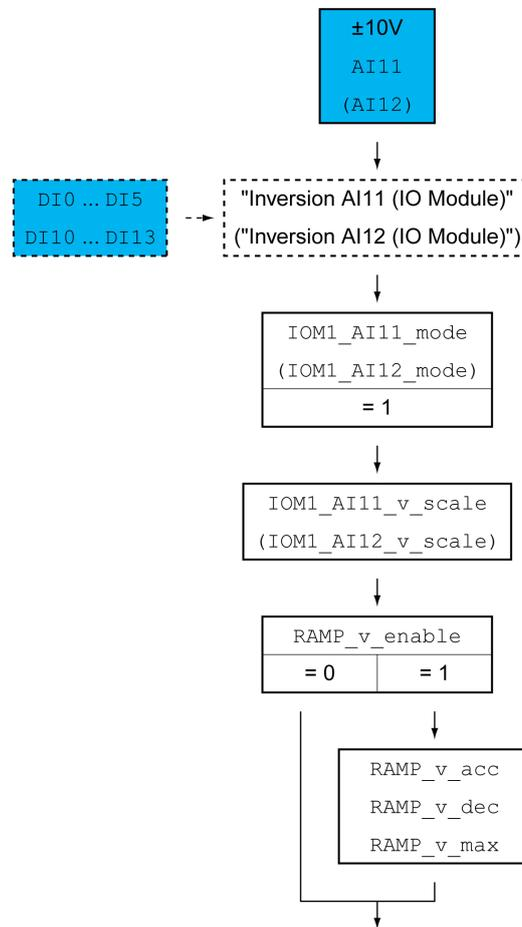
以下图表显示了现场总线控制方式下可进行设置的参数的概况：
