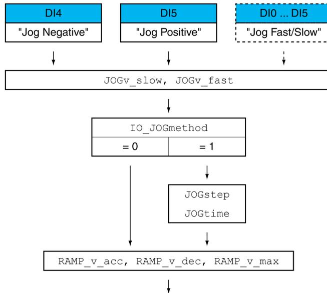
以下图表显示了现场总线控制方式下可进行设置的参数的概况：
