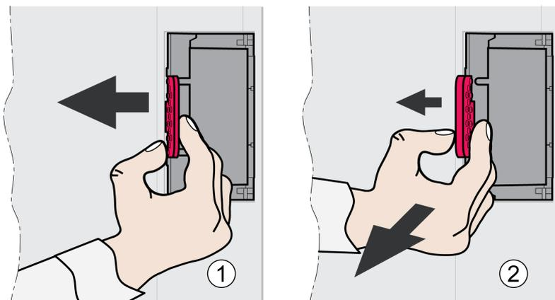
插拔模块之前，必须切断所有电源（输出级电源和 24 Vdc 控制电源）。
