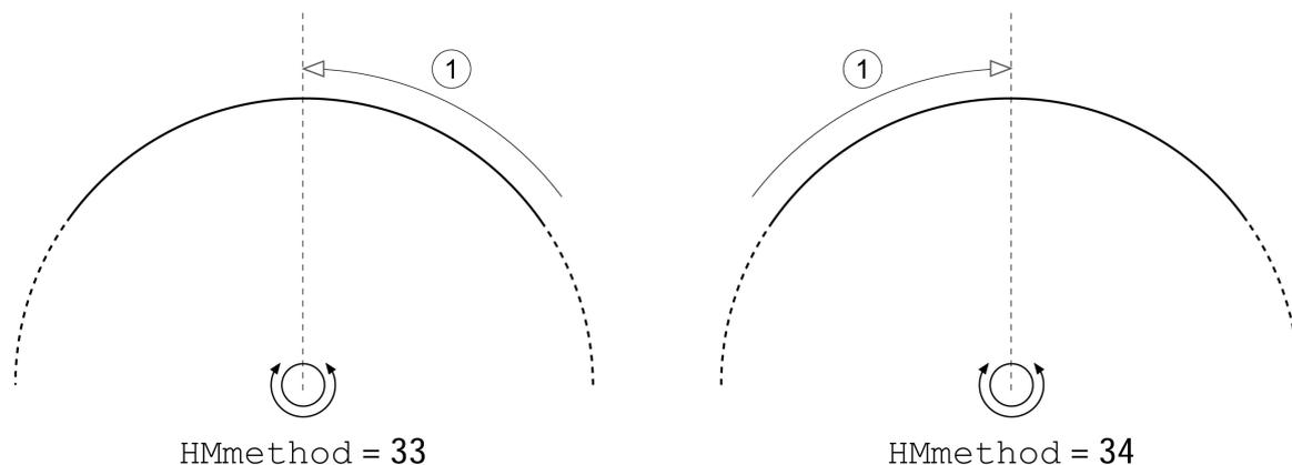
1 以  $HMv\_out$  的速度朝向标志脉冲运动
